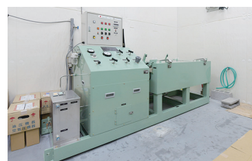
破壊圧試験機
